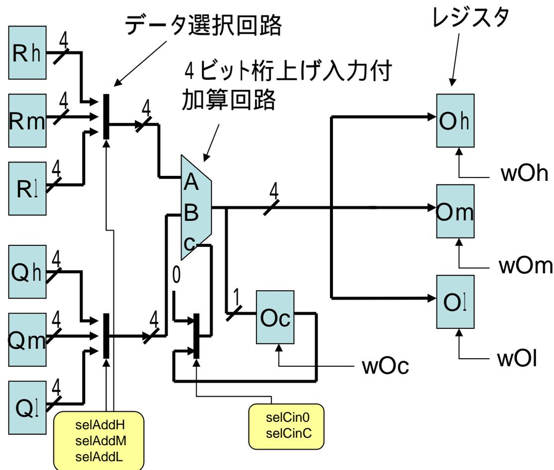
ブロック図の回路を12ビット加算器として動作させる状態遷移図を作成せよ
